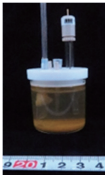
図1 自然電位測定試験に用いた装置写真
