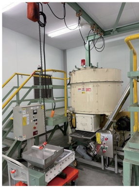
図 18 迅速炭酸化処理に用いたミックスマラー混練機 Mix muller used for rapid carbonation experiments
