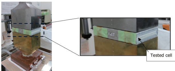
図 5 温度傾斜法による電池の熱伝導率測定 Measurement of battery thermal conductivity using the temperature gradient method
