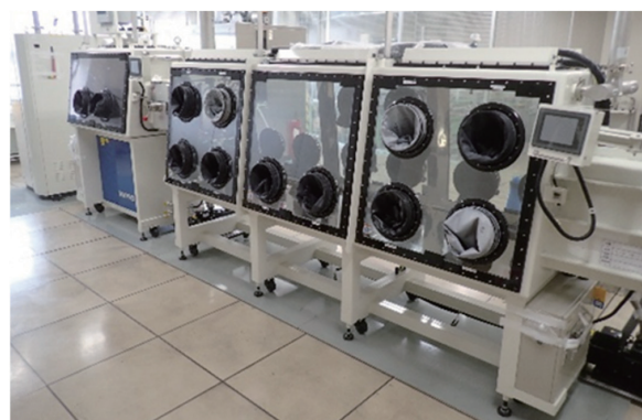
図 2 グローブボックス (露点<-90°C) Globe box for LIB prototyping (DP<-90°C)
