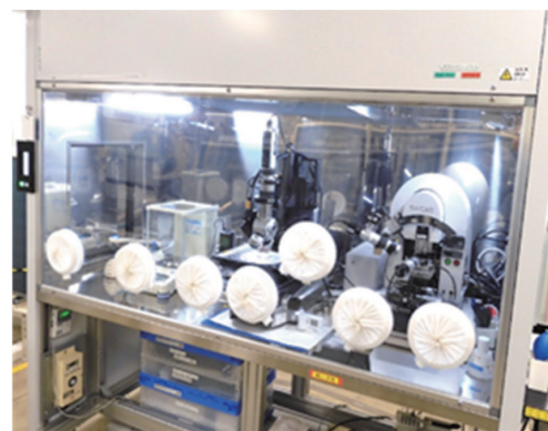
図 3 ドライブース (露点<-60°C) Dry booth for LIB materials analysis (DP<-60°C)
