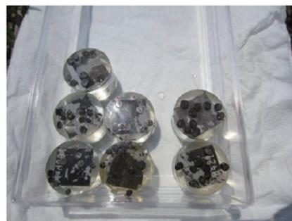
図1 スラグ肥料の樹脂包埋試料(水田静置前)
