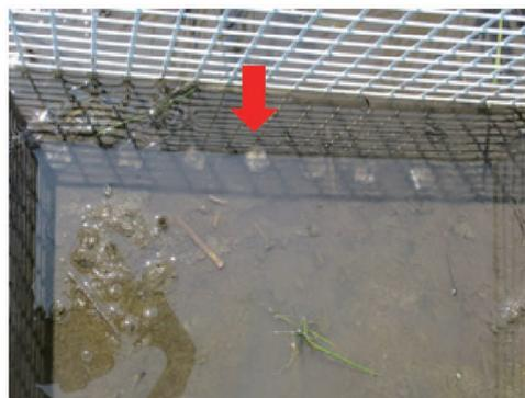
図2 水田に設置したスラグ肥料の樹脂包埋試料
