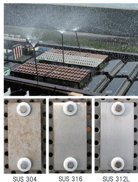
図3 海水シャワー暴露試験 2) Seawater shower exposure test 2)
