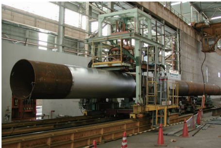
図8 インダイレクトシーム・プラズマ複合溶接設備 4,5) Equipment for automatic combined welding 4,5)
