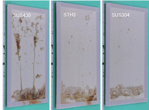
図10 複合サイクル試験後(JASO, 30cyc)の外観 評価面 #600
