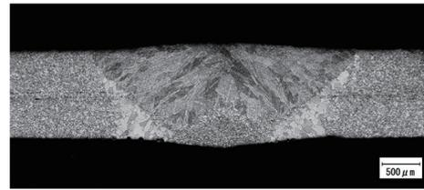
図9 TIG溶接材のマイクロ組織
