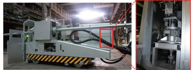
図9 H-QMIシステムを搭載した転炉用吹付装置外観
