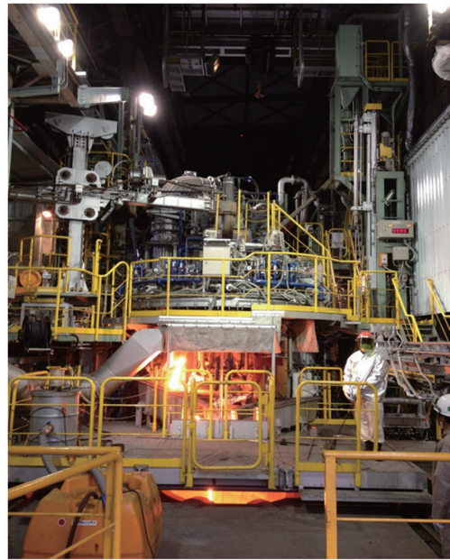
図5 TEST 3における出滓状況 Slag tapping operation at TEST 3
