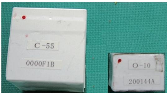
図 5 作成した RFID タグを内蔵した模擬粒子
