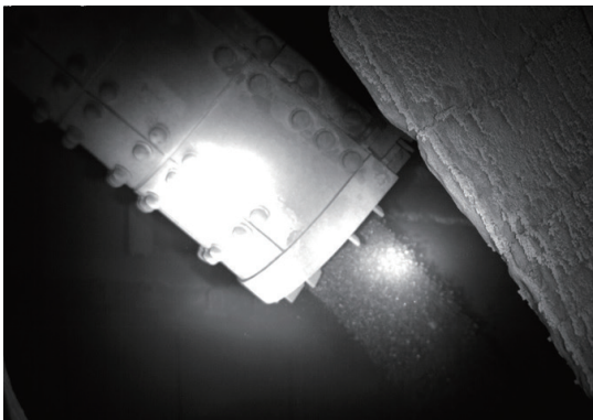
図 15 名古屋 3 高炉で高速カメラを用いて撮影した焼結鉱装入の様子 27)
