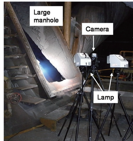
図6 名古屋3高炉での高速カメラ撮影のセットアップ 27) Picture of setup of high-speed video camera in Nagoya No.3 BF 27)
