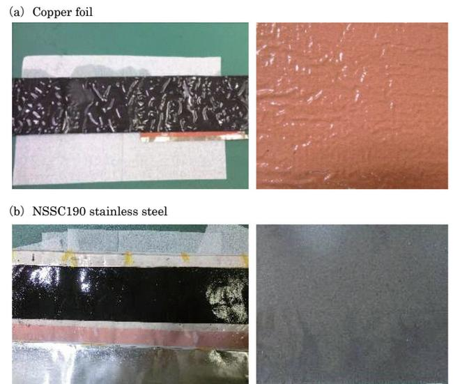
図 14 SiO/LiFePO<sub>4</sub> セルを充放電した後の(a)Cu 箔および(b)NSSC190 ステンレス鋼箔集電体
