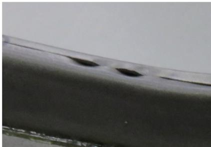
写真1 骨組みレインフォースメントの突き合せ端部の波形状
