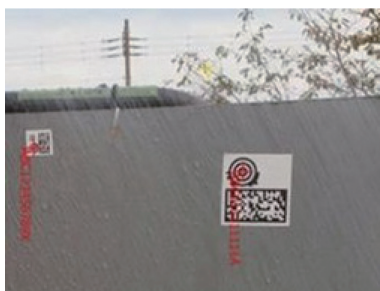
図13 TEXコードの降雨想定読み取り例 Sample of recognition in rain
