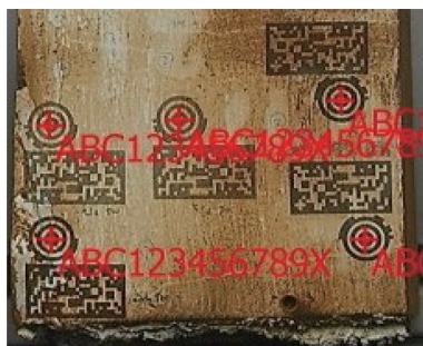
図12 TEXコードの錆在時の読み取り例 Sample of recognition with rust
