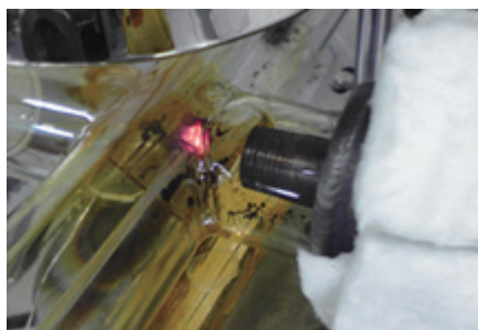
図3 コークス着火時の様子(撮影のため光加熱は一時的に消灯) State of coke ignition (light heating temporarily turned off for photographing)
