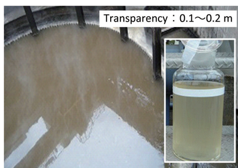
図 12 NCST 適用前後のスケールピット外観および、スケールピット処理水 左：NCST 適用前，右：NCST 適用後 Appearance comparison of the scale pit and the treated water Left: Before applying NCST, Right: After applying NCST
