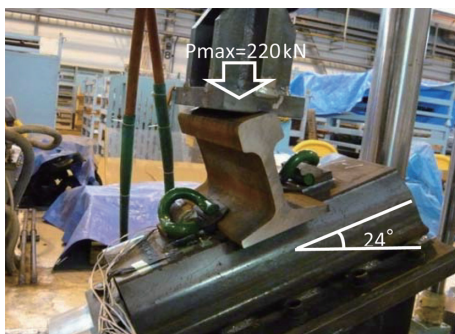
写真3 疲労試験概要 Fatigue test
