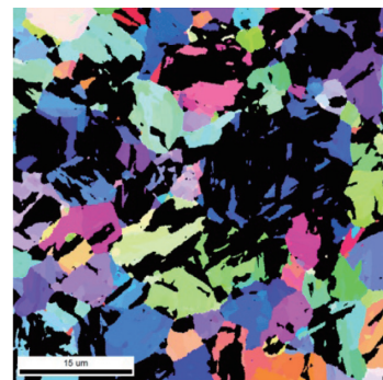
図4 オーステナイト方位が1つだけ見出されたフェライト粒のみを用いて再構築したオーステナイト組織解析 Reconstructed \gamma microstructure using the \alpha grains in Fig. 1 which has just one candidate \gamma orientation
