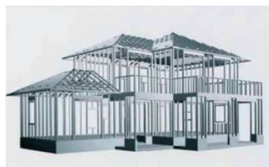
写真1 スチールハウスと薄板軽量形鋼 Steel framed house and light-gauge shaped steel
