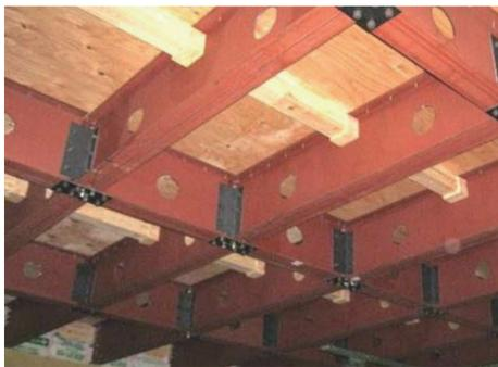
図 14 対策後の試験体（床下から見上げ）
