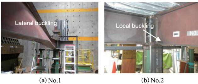
写真 5 最終破壊状況
