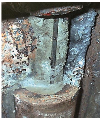
写真6 嵌合継手内の状態 4) State in the joint
