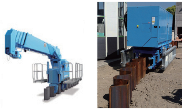
写真4 ノンステーキング圧入工法 2) Driven hat-type sheet pile by hydraulic jacking method
