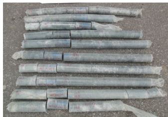
写真3 鋼管内から採取されたコア Soil-cement core bored from pile
