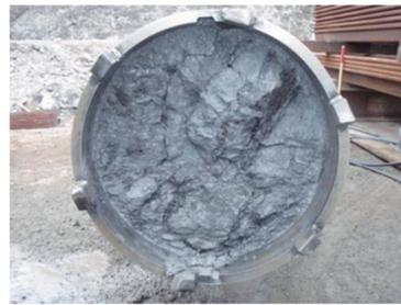
図10 鋼管内閉塞状況
