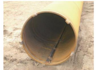
図2 先端ビット付き鋼管杭
