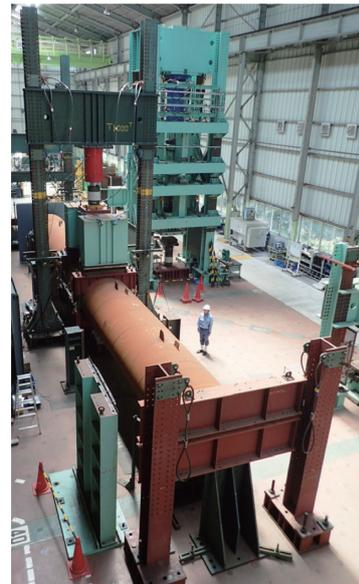
写真2 曲げ試験 (φ1600 × t19mm)
