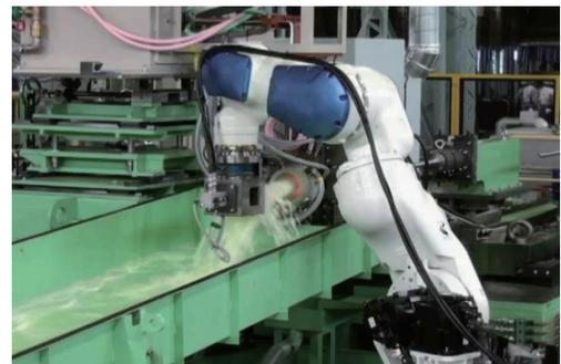
写真2 加工中の曲げロボット外観
