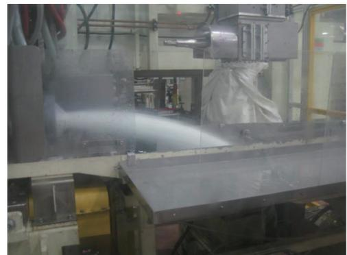
写真1 冷却ノズルからの焼入れ水の散水
