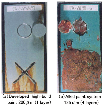
写真5 厚膜塗料と一般塗装との防食性能比較 (SST2000時間後)
