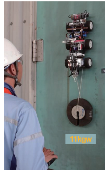
図 16 S2 ローバーの積載能力テスト Payload capacity test of S2 Rover
