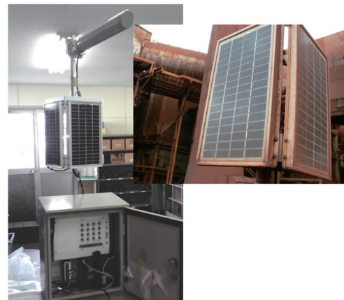
写真3 屋外自律型診断装置の概要 Solar-powered wireless CDT system
