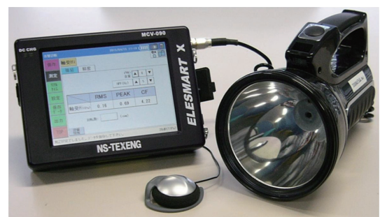
写真2 パラボラ型マイクロホンと携帯端末 (日鉄住金テックスエンジニアリング(株)提供) Parabolic microphone and compact data analyzer
