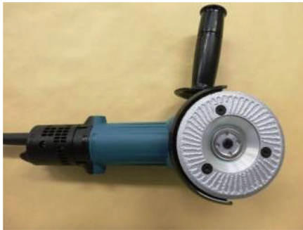
図 16 ダイヤツール外観 Grinder with manmade diamond grains
