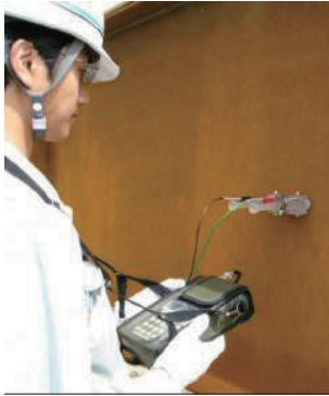
図 15 イオン透過測定外観 Ion transfer resistance measurement (RST)
