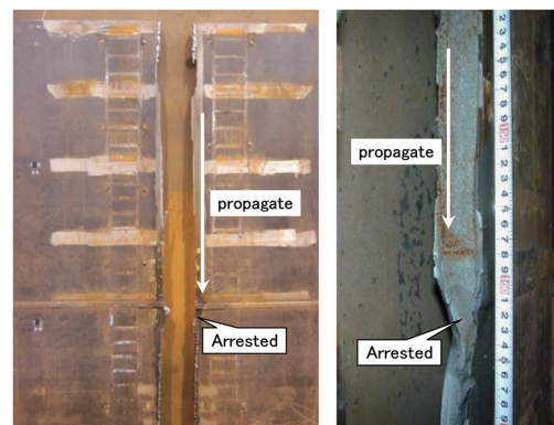
図7 大型破壊試験の例
