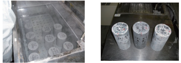
写真 1.3 試験状況 Expansion test of concrete
