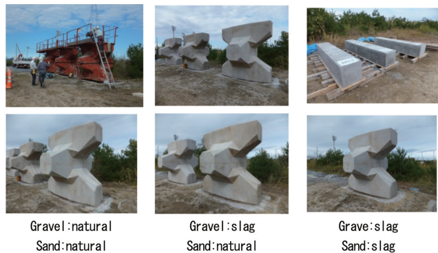
写真 1.5 脱枠状況 Form removal situation
