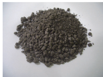
写真3 製鋼スラグ Steelmaking slag
