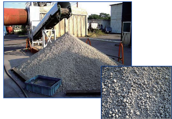
写真4 試運転時の炭酸化処理された製鋼スラグ Carbonated steelmaking slag at the trial run
