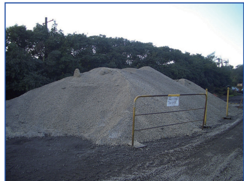
写真7 堺向け炭酸化スラグ (< 5mm, 約250トンの山) Carbonated steelmaking slag for National Project
