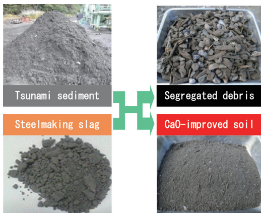
図2 がれき混じり泥土の分別, 改質結果の一例 Example of segregation/improvement
