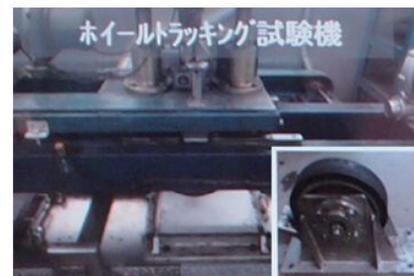
写真1 ホイールトラッキングの試験の状況
