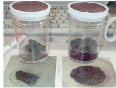
写真9 敷設されたカタマ®SPと製鋼スラグをフェノールフタレイン溶液に浸けた状況の比較
