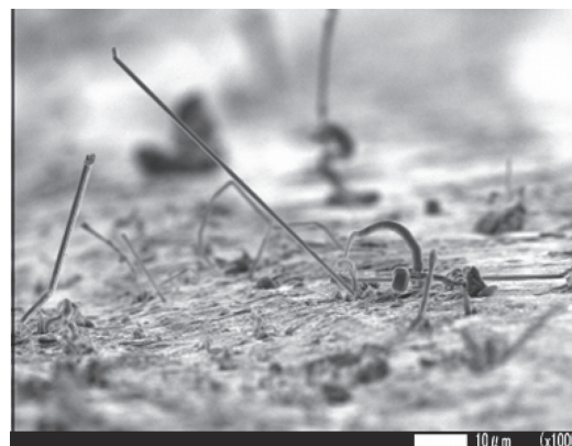
写真1 ウイスカの例 ブリキ, 条件 (a) Example of tin whisker, TinPlate, Condition (a)
