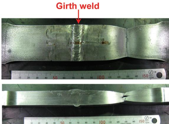
図8 継手引張り試験破断部外観
