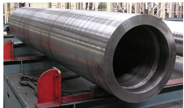
写真4 試作した HR6W 大径厚肉管の外観 (635mm 径 × 72 mm 厚)
