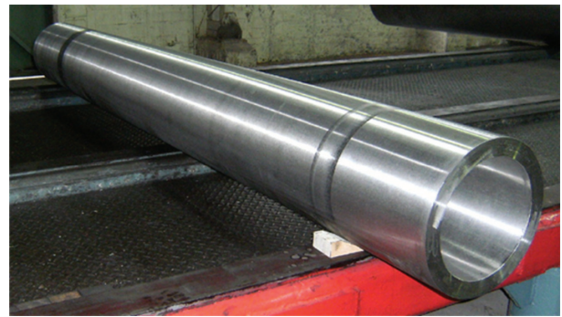
写真8 試作したHR35大径厚肉管の外観(350mm径×40mm厚) Appearance of HR35 thick-wall pipe
