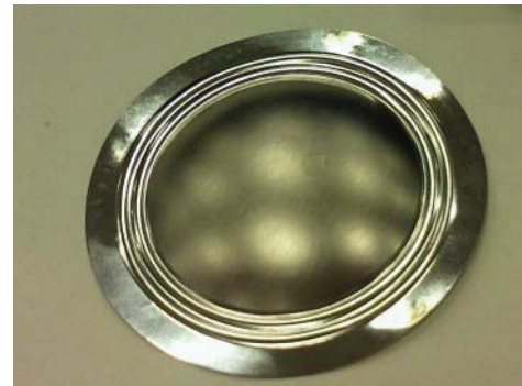
図8 スピーカー振動板加工例 Example of speaker diaphragm
