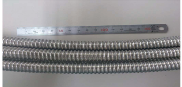
図4 NSSMC-NAR-DP-3W 製フレキシブル管（0.2mm厚×20mm径） Flexible tube of NSSMC-NAR-DP-3W (0.2mm thickness × 20mm diameter)
