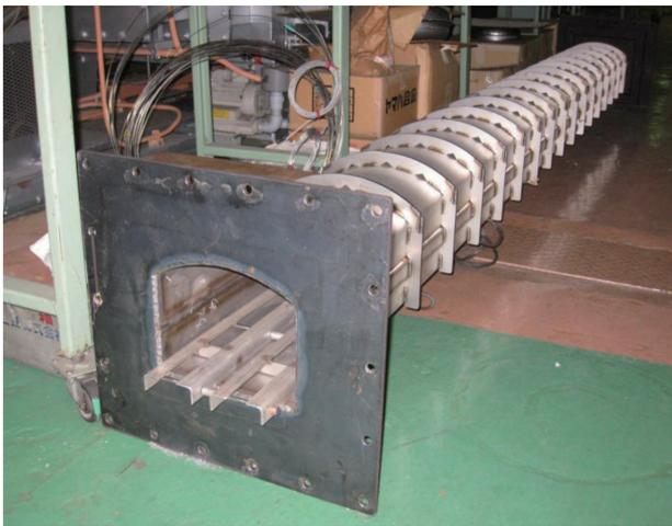
写真3 工業炉適用例（マッフル本体 関東冶金工業(株)）
