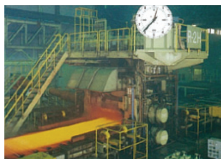
図5 厚板圧延用 2Hi 熱間圧延機 Hot rolling mill for stainless steel plate
