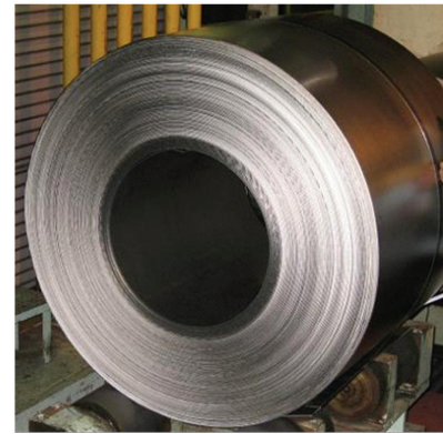
写真2 実機製造した Super-TIX®51AF 熱延ストリップの外観 3.9mm厚×835mm幅, 3.7tonインゴットより製造
