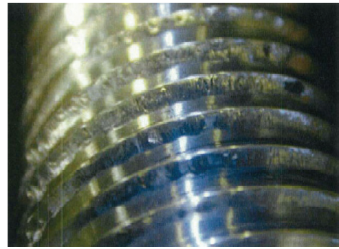
図 15 ローラスクリュの損傷 Failure of roller screw
