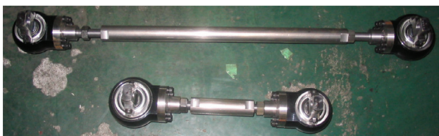
図 18 固渋治具（上：一両モデル試験用，下：台上試験用） Bar for simulating sticking
