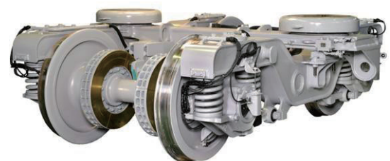
図16 PQモニタリング台車 Track condition monitoring bogie
