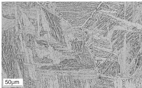
写真3 Ti-6Al-4V製吸気エンジンバルブの光学顕微鏡組織
