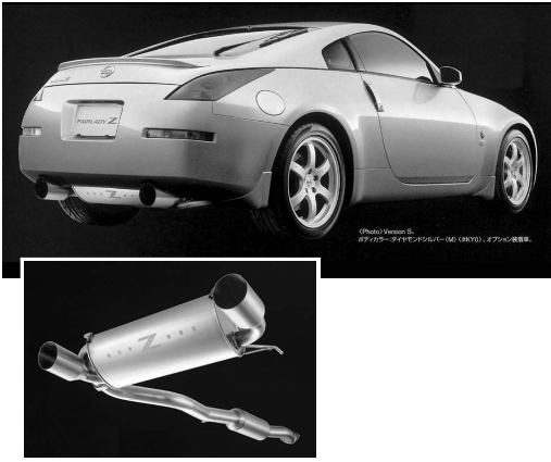
写真2 チタン製マフラーの四輪車への適用例
