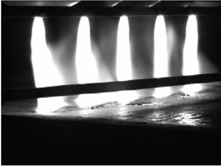
図12 ベンチスケール試験装置でのプラズマアークの挙動
