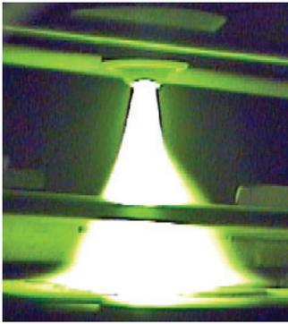
図3 交流磁場で振動する直流アークプラズマの様子<sup>16, 17)</sup>
