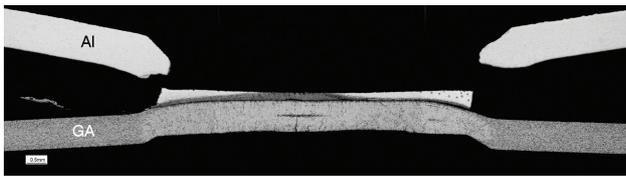
図3 引張試験後の溶接部断面マクロ写真(溶接電流29.5kA)
