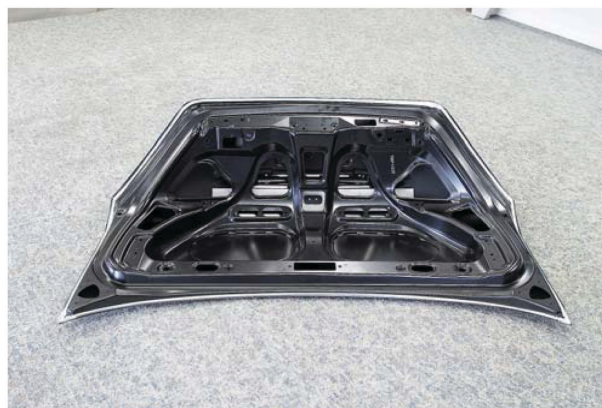
図9 高温ブロー成形により加工されたトランクリッドインナー。当社と古河スカイ(株)が開発した廉価合金を使用
