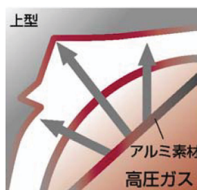
図7 高温ブロー成形の概要。融点直下の温度にて成形
