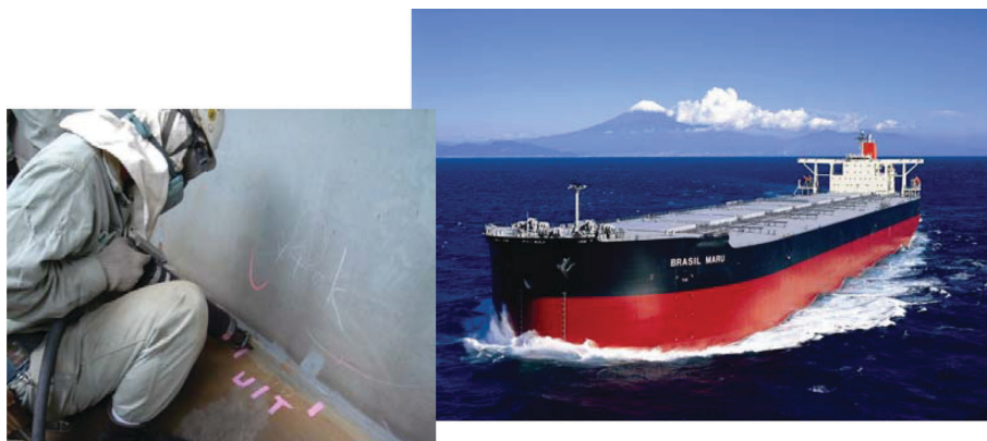
図 8 鉱石運搬船ぶらじ丸 (写真提供:三井造船(株)) でのUIT施工 (ホールド内)
